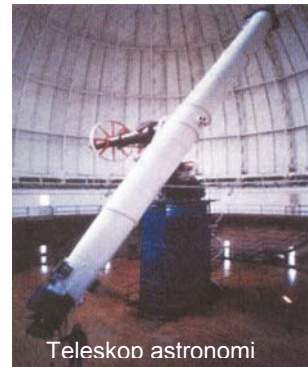
Gambar 12.49 Teleskop pembias di Yarkes Observatory, mempunyai lensa obyektif dengan diameter 102 cm dan panjang tabung teleskop 19 m
