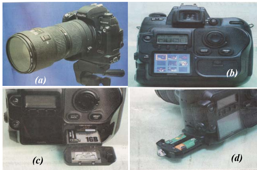
Gambar 12.41. Kamera terkini yang dilengkapi dengan pemfokus dan external memori untuk menyimpan data digital (a) tampak depan (b) tampak belakang (c) external memori (d) baterai yang bisa diisi ulang.
