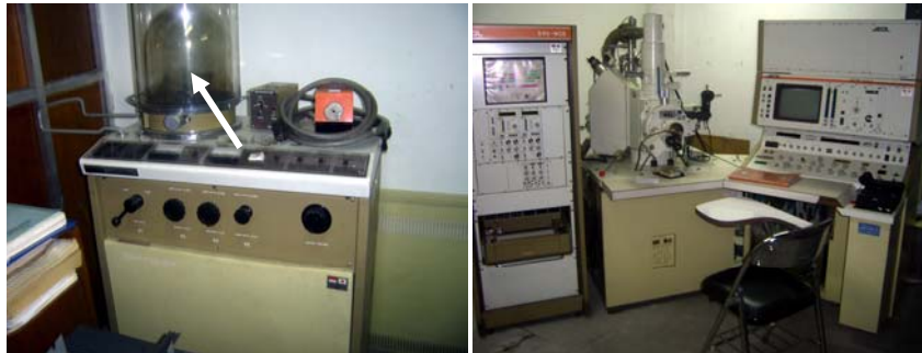
Gambar 12.53 (a) Preparasi sample, tempat coating sample dengan emas atau karbon (b) Mikroskop electron dan perlengkapannya
