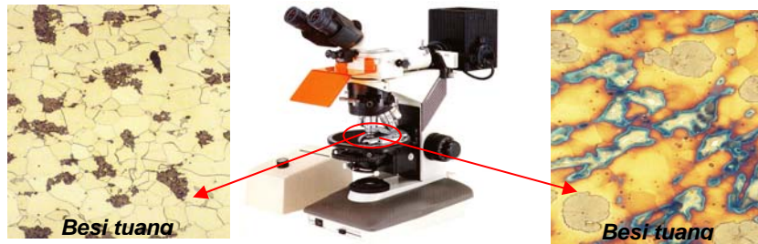
Gambar 12.52 Mikroskop optik dan hasil pemfotografan mikrostruktur logam
